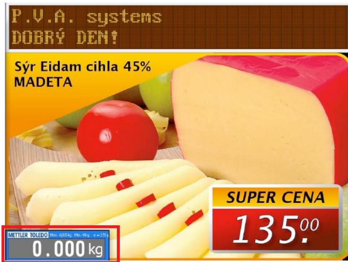
Obrázek 6: Virtuální softwarový displej VCODisp – zákaznický displej – průběžné vážní okno (klidová poloha), včetně informací o metrologických parametrech váhy
