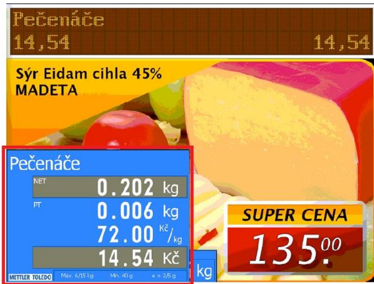
Obrázek 8: Virtuální softwarový displej VCODisp – zákaznický displej – zboží vybráno a zváženo včetně použití předvolené táry
